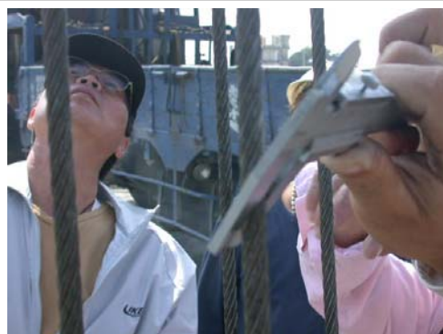
圖3-8、除鋼索直徑實際量測也需檢查鋼索表面磨損情況
