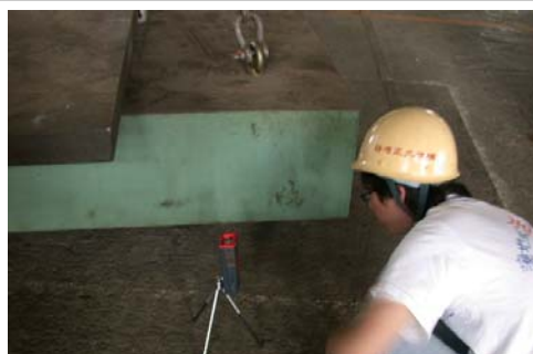
圖3-6、以雷射測距儀量測桁架的撓度
