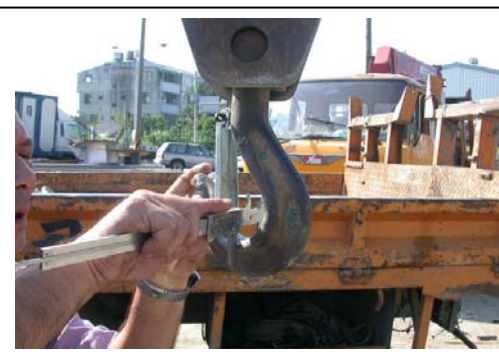
圖3-14、量測吊鉤各部尺寸
