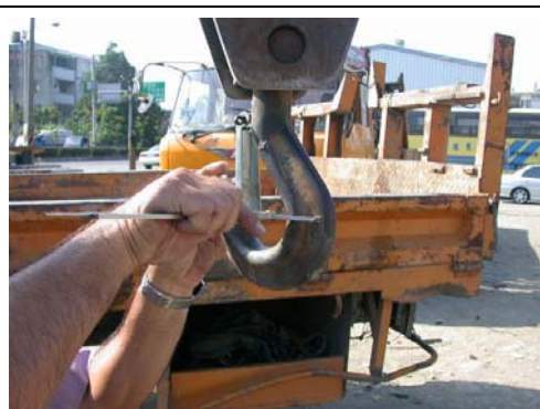
圖3-12、量測吊鉤各部尺寸
