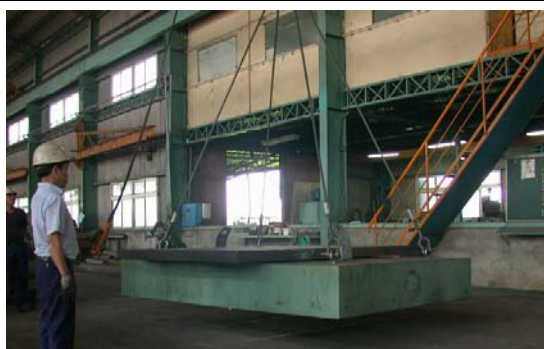
圖3-5、進行額定荷重的吊升試驗
