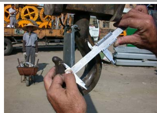
圖3-11、吊鉤開口變形量
