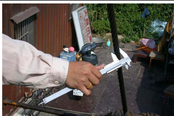
圖3-7、鋼索直徑實際量測
