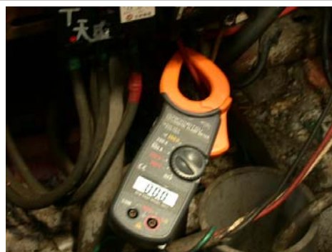
圖3-10、以電流計量測起重機在吊升作業時的電流值
