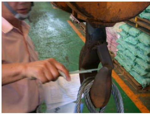
圖3-15、量測吊鉤各部尺寸
