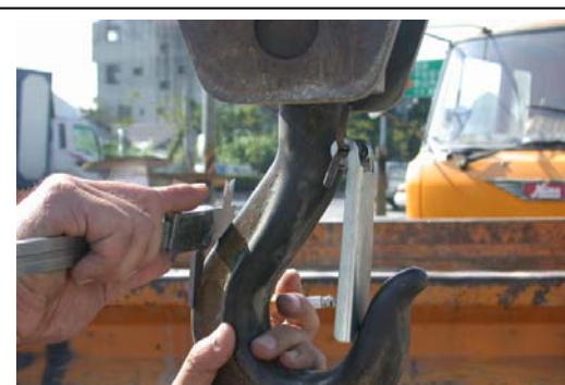
圖3-13、量測吊鉤各部尺寸
