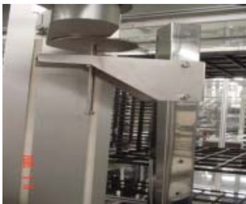
圖2.7 Z軸機構之安全防護措施
