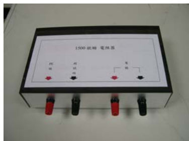
圖21、自製阻抗電路與電位計
